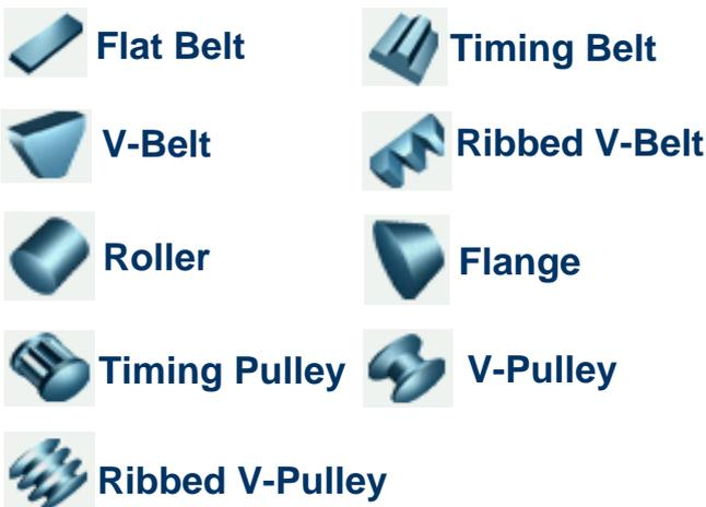
RecurDyn/Belt擁有皮帶滑輪幾何形狀生成器可生成各式類型的皮帶與滑輪。使用者只需選擇所需的皮帶滑輪類型，輕鬆點擊各個部件就可成整個皮帶系統的裝配，並自動定義皮帶與滑輪之間的接觸作用力，可以精確地給出系統在運動過程中的動態特性。可應用於CVT(無段連續變速器)分析。
