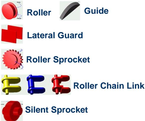
RecurDyn/Chain 可輕鬆完成鏈條的裝配。用戶只要點擊需連接的部件，即可完成鏈條的裝配過程。裝配資訊包含了鏈條系統的全部資訊：接觸參數、襯套特性、鏈節數、鏈節形狀及接觸力輸出資訊等。可應用於靜音鏈條設計分析等。
